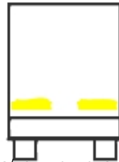
Контурная маркировка бортового автомобиля и бортового прицепа/полуприцепа
