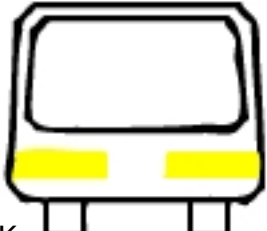
Контурная маркировка автомобиля кадетной комплектации с кузовом фургоном. Контурная маркировка
