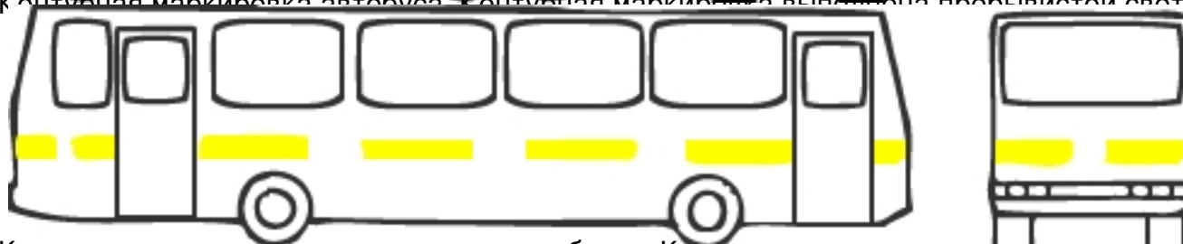
Контурная маркировка сочлененных автобусов. Контурная маркировка выполнена прерывистой
