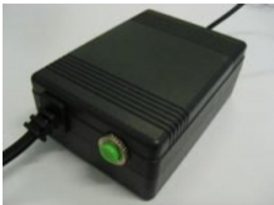
Инверторы для холодного неона
